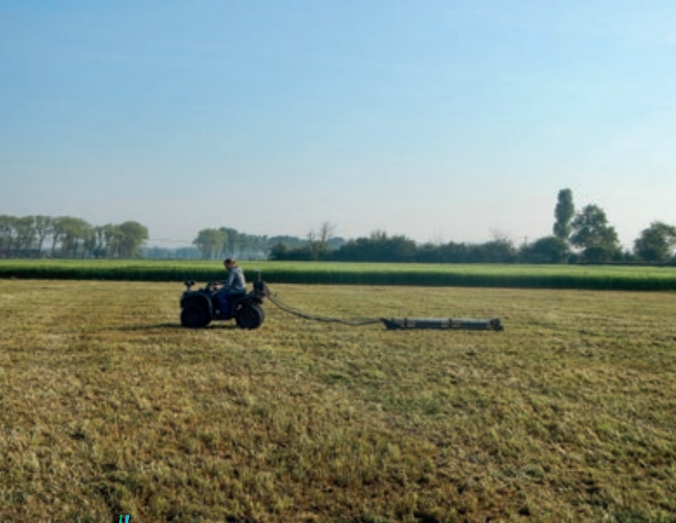
Een quad trekt de EMI-sensor in parallelle stroken over het terrein (foto: Jan Trachet, © Universiteit Gent).
